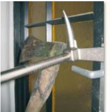
Gewaltsamer Zutritt: Setzen Sie die Querschneide etwa 10-15 cm über oder unter das Schloss zwischen Tür und Zarge. Treiben Sie sie mit einer Axt in die Zarge, durch eine Drehbewegung nach unten wird die Tür aufgehebelt. Je nach Anwendung kann die Axt auch als Hebelauflage oder als Keil genutzt werden. Vorhängeschlösser können durch Einschlagen des Dorns geöffnet werden.
