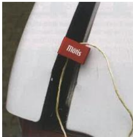
Heckklappe: Mit dem Halligan-Tool wird ein Spalt geschaffen und mit einem Keil offenhalten
