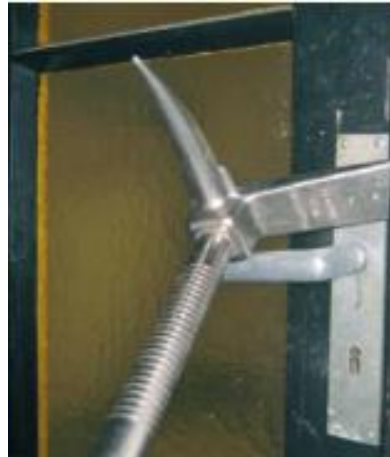
Gewaltsamer Zutritt: Setzen Sie die Querschneide etwa 10-15 cm über oder unter das Schloss zwischen Tür und Zarge. Treiben Sie sie mit einer Axt in die Zarge, durch eine Drehbewegung nach unten wird die Tür aufgehebelt. Je nach Anwendung kann die Axt auch als Hebelauflage oder als Keil genutzt werden. Vorhängeschlösser können durch Einschlagen des Dorns geöffnet werden.
