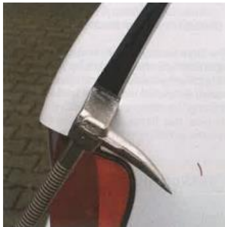
Heckklappe: Mit dem Halligan-Tool wird ein Spalt geschaffen und mit einem Keil offenhalten
